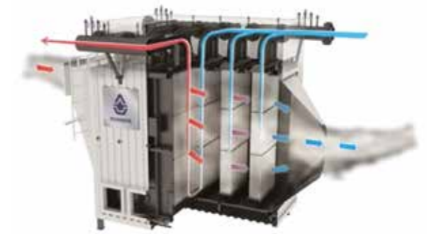
Рисуюнок 14 – Загальний вигляд та конструкція економайзера
