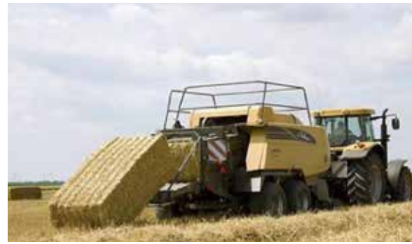
б) AGCO Challenger для формування прямокутних тюків
