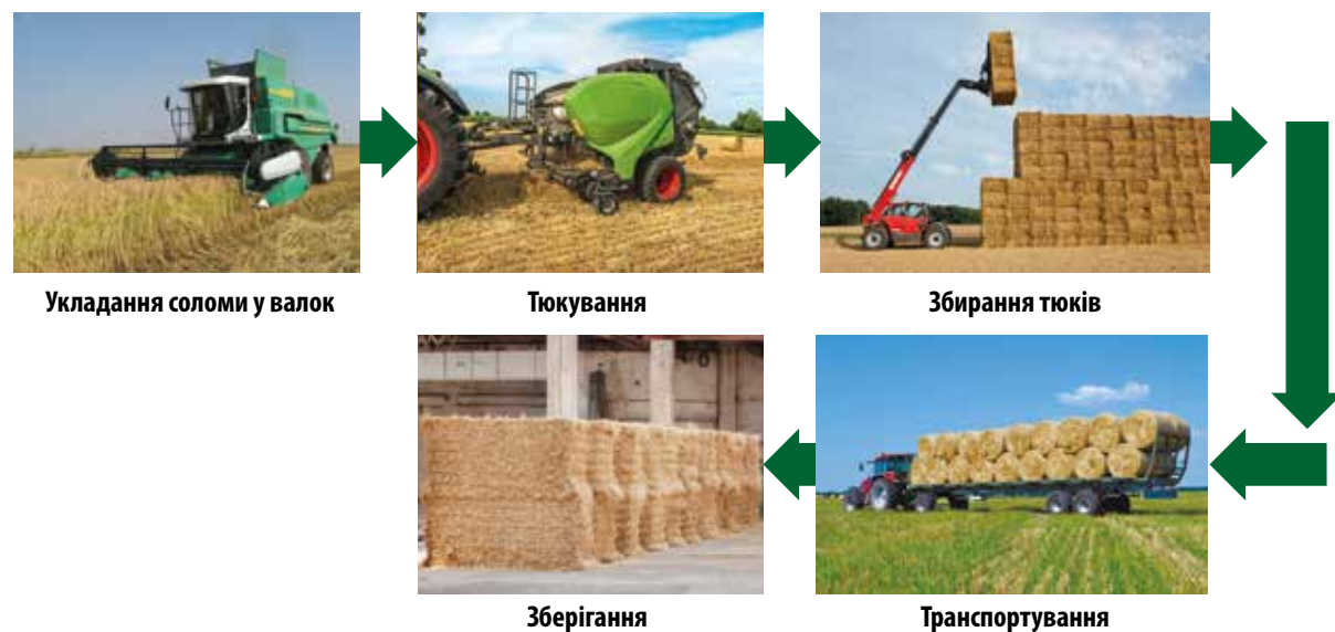
Рисунок 9 – Схема організації виробничого процесу по заготівлі тюкованої соломи
