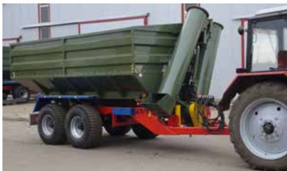
Рис. 4.28. Загальний вигляд бункера-накопичувача золи ПБН-16
