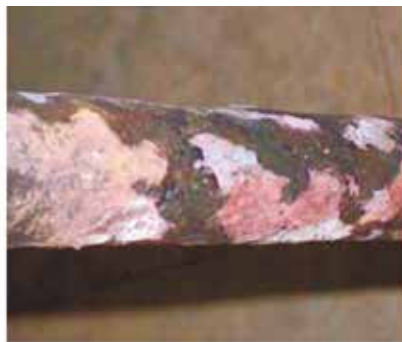
Хлорна корозія пароперегрівача
