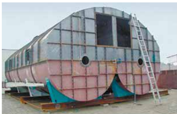
д) трубчаста сушарка Buttner 25
