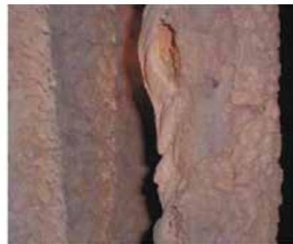
Відкладення на конвективних поверхнях
