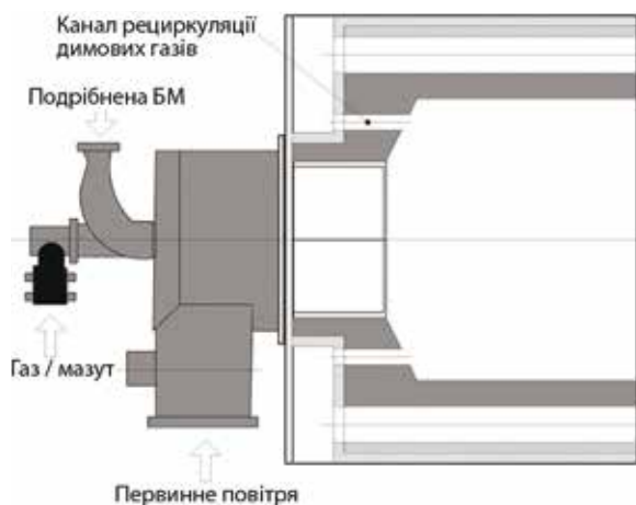
Рис. 4.20. Пальник для пилового спалювання БМ
