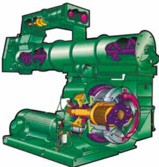
а) прес-гранулятор CPM 7930-4 з двигуном 250 або 315 кВт, продуктивністю 4–5 т/год
