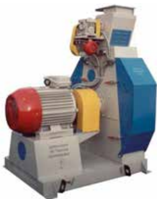
а) молоткова дробарка типу ДМ-2Р продуктивністю до 10 т/год 11
