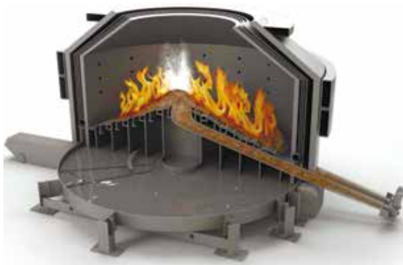
Рис. 4.11. Обертальна решітка з нижньою подачею палива
