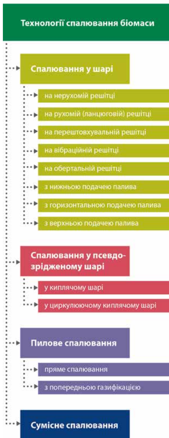
Рис. 4.1. Основні технології спалювання
