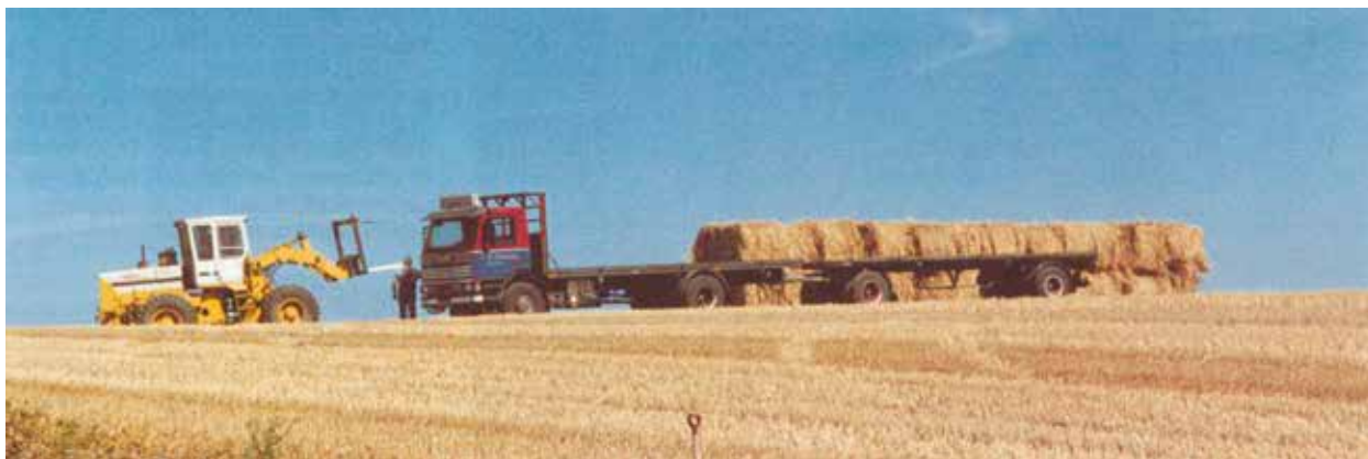
Рис. 3.17. Трактор-навантажувач може завантажити 24-ма великими тюками вантажівку і причіп
