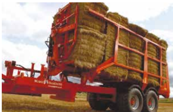
Рис. 3.13. Автоматичний причіп для збирання, транспортування та вивантаження тюків соломи
