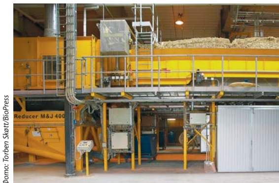
Соломенные тюки идут в режущую машину на заводе Koge Bio Pellet.
