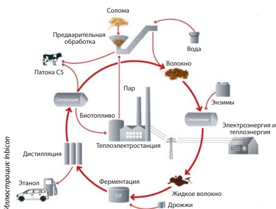
Рисунок 11. Схема производства этанола на предприятии Inbicon. Схема производства этанола из соломы на предприятии Inbicon. Центральный элемент – предварительная обработка соломы, которая проходит под давлением 15 Бар и при температуре 185 C0. Производство биоэтанола происходит совместно с энергетической установкой, что позволяет использовать избыточную теплоэнергию для производства этанола. К тому же, энергетическая установка может утилизировать часть биомассы, оставшейся от производства этанола, в качестве топлива.
