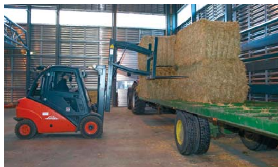
Разгрузка соломы на станции централизованного теплоснабжения Thisted. Автомобильный погрузчик забирает соломенные тюки, лежащие далеко. Использование автомобильного погрузчика позволяет разгружать солому из фургона с обеих сторон.
