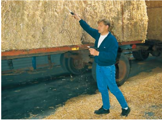
Перед выгрузкой соломы из фургона замеряется уровень содержания воды в ней. Если содержание воды более 25%, установки, как правило, не берут такую солому.
