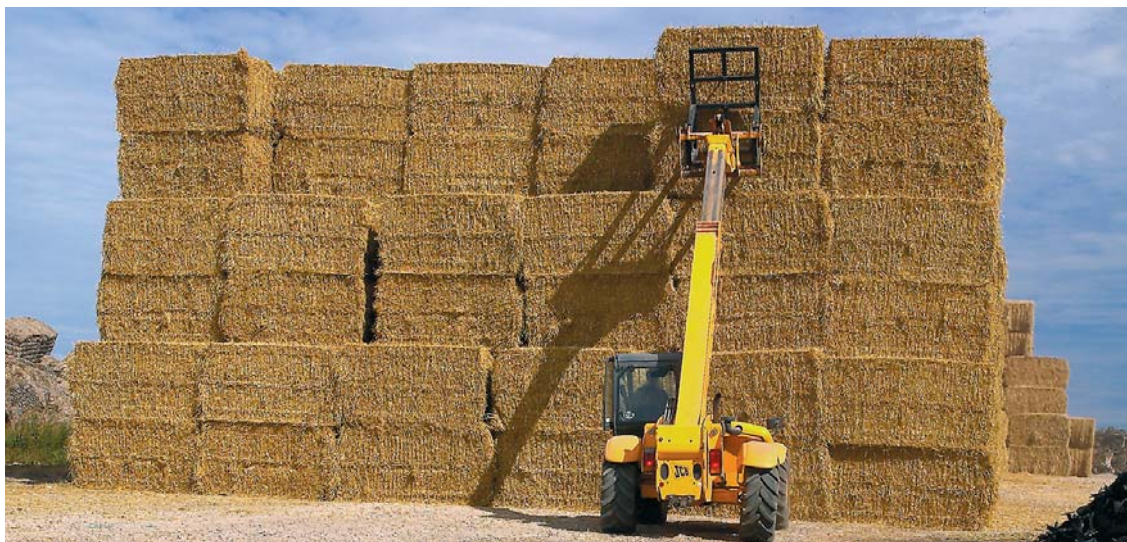
С помощью телескопического погрузчика соломенные тюки можно складывать в более высокие штабеля, чем при помощи автопогрузчика и фронтального погрузчика.
