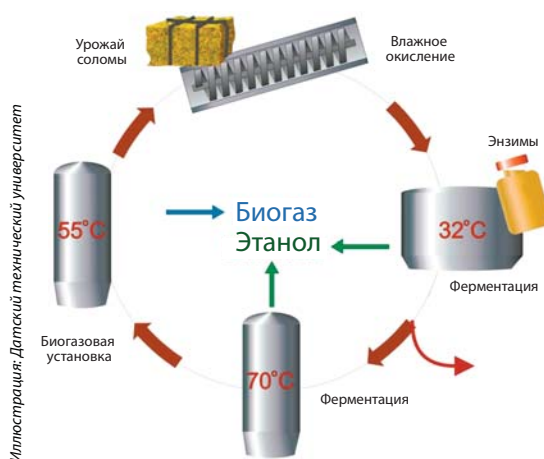
Рисунок 12. Схема производства этанола на предприятии Biogasol. Предварительная обработка биомассы осуществляется под давлением с добавлением мягкой кислоты, что приводит к распаду волокон соломы. В результате химические цепочки сахарозы готовы к последующей обработке с помощью энзимов и/или ферментации. Более того, компания Biogasol вывела генетически модифицированные термофильные микроорганизмы, которые превращают сахар C5 в этанол, а также увеличивают выработку этанола из соломы на 30-40%.
