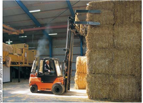
Тюки соломы выгружаются из фургона и складываются в хранилище с помощью автопогрузчика. Солома выгружается в пределах зоны, отмеченной желтым цветом, что позволяет крану автоматически захватывать соломенные тюки.
