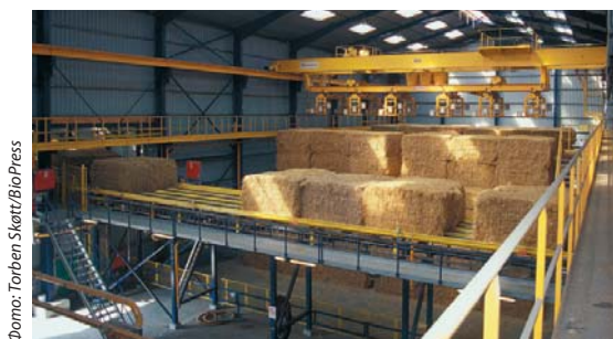
Хранилище соломы на энергетической станции Ensted в г. Aabenraa. Кран поднимает 12 соломенных тюков за раз.
