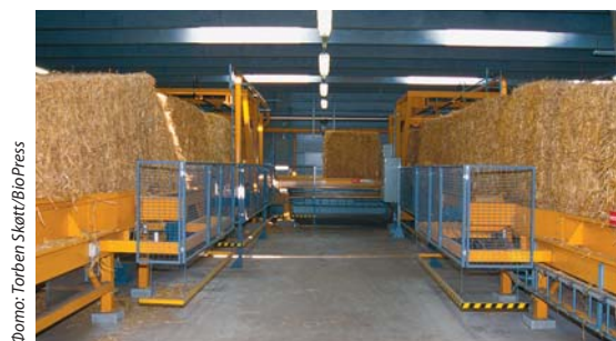
Соломенные тюки транспортируются к измельчителю по конвейерной ленте – так называемым "соломенным лентам".
